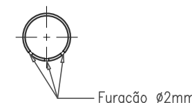
DETALHE DA FURAÇÃO DA TUBULAÇÃO ASPERSÃO - ESC. 1:2,5
